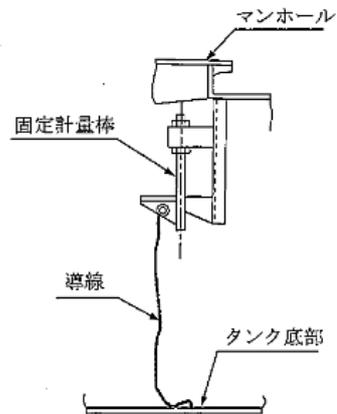
第8-47図 計量時の静電気による災害を防止するための装置
