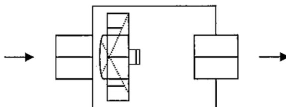
第 8-62 図 火炎噴出防止装置の構造例（遠心式の場合）
