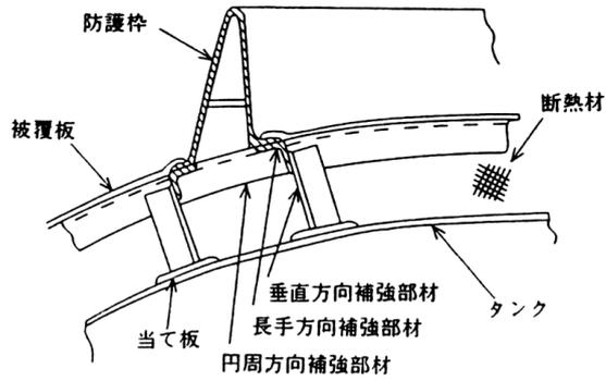
第 8-27 図 被覆板の下部に補強部材を設ける防護枠（溶接接合する場合）
