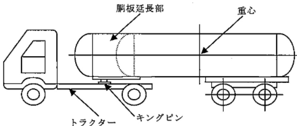
第8-55図 胴板を延長した移動タンク貯蔵所の例
