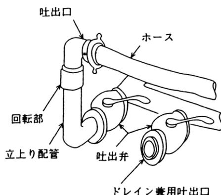
第 8-46 図 配管先端部の構造例
