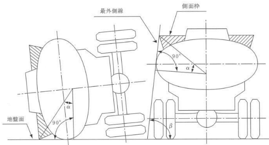
第8-17図 側面枠取付図
