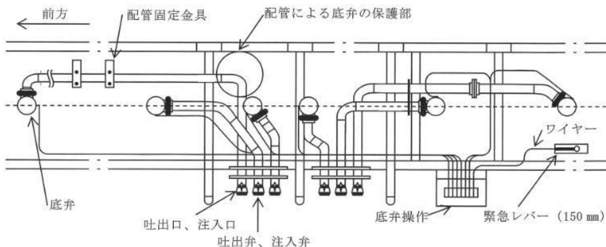
第 8-56 図 ボトムローディング配管の例 (片側)
