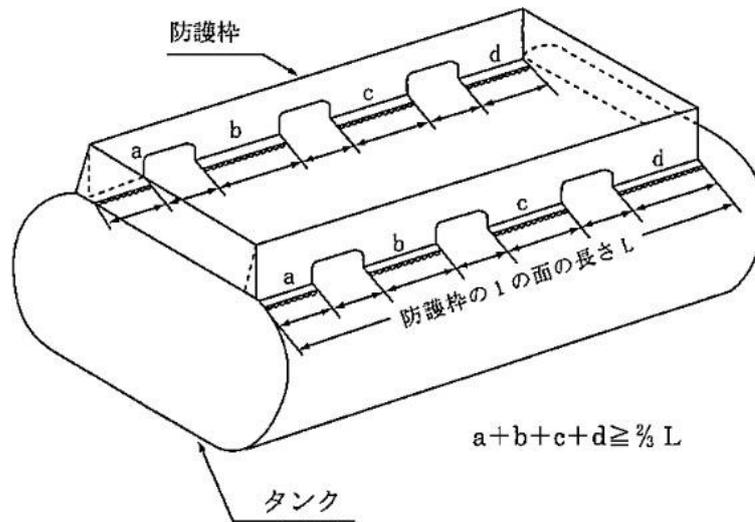
第8-30図 防護枠とタンク胴板との間の溶接線の減少例
