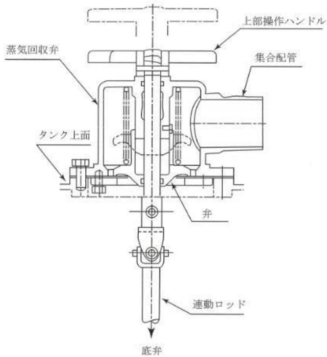
第8-11図 蒸気回収弁の構造例
