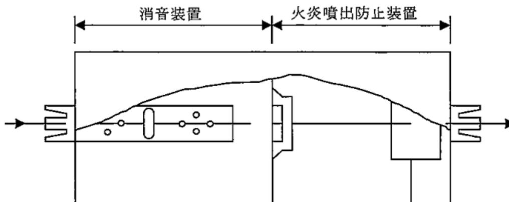
第 8-63 図 消音装置と火炎噴出防止装置を一体として取付ける場合の例
