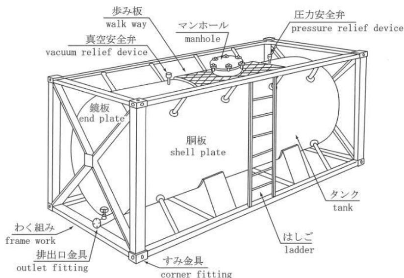
第 8-71 図 国際輸送用タンクコンテナの例
