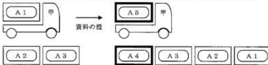
③ タンクコンテナの他車両への積載
