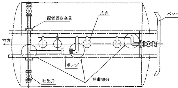
第8-39図 配管による方法
