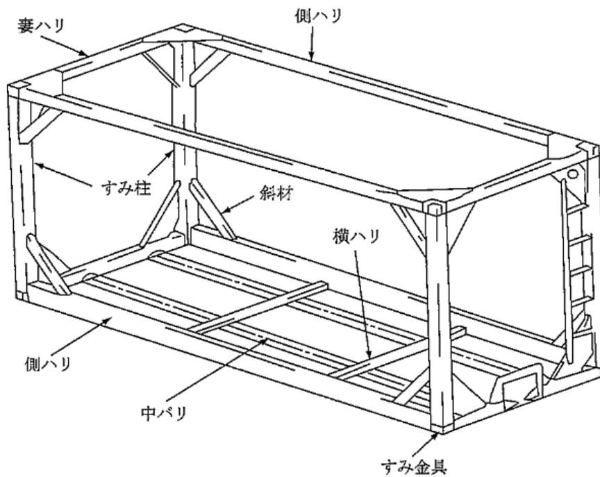
第 8-60 図 箱枠の部材名称及び構造
