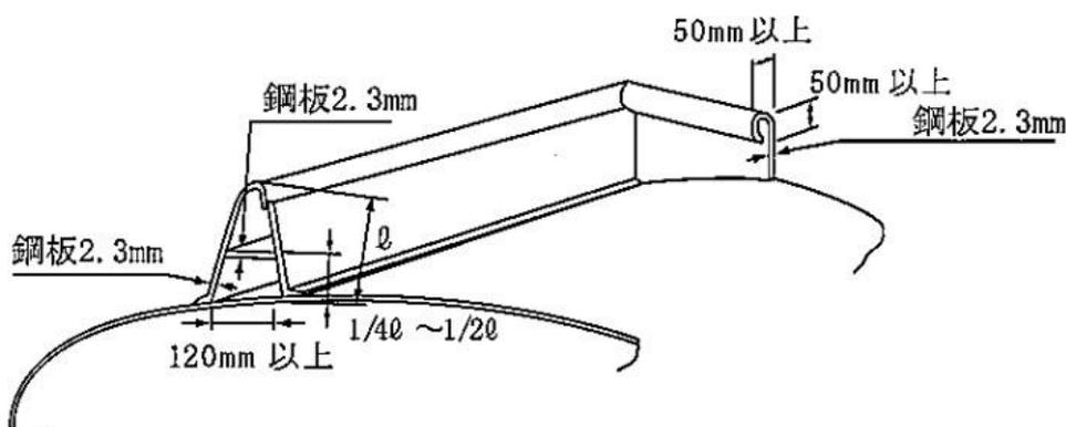
第8-26図 防護枠の構造
