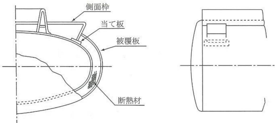
第 8-21 図 タンク胴板に直接取り付ける側面枠の例
