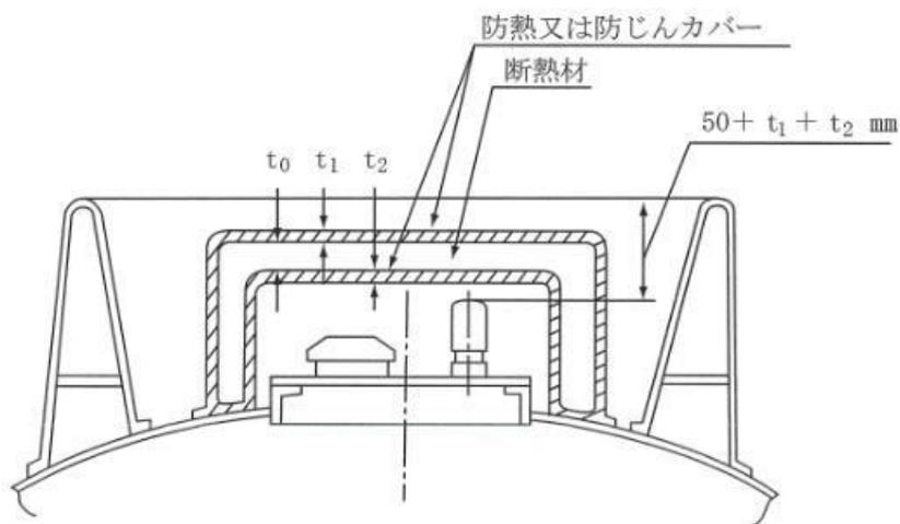
第 8-25 図 防熱又は防じんカバーを設ける移動貯蔵タンクの防護枠
