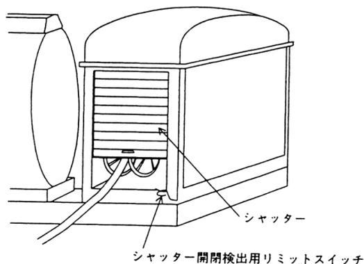
第8-66図 給油設備の扉による方法の例
