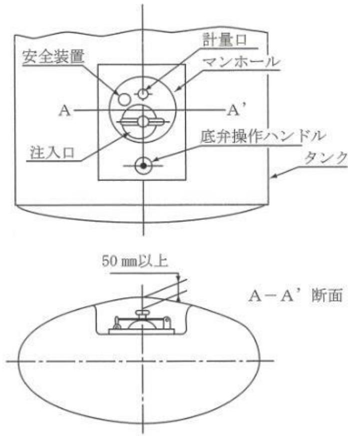
第 8-24 図 附属装置が陥没しているタンクの例
