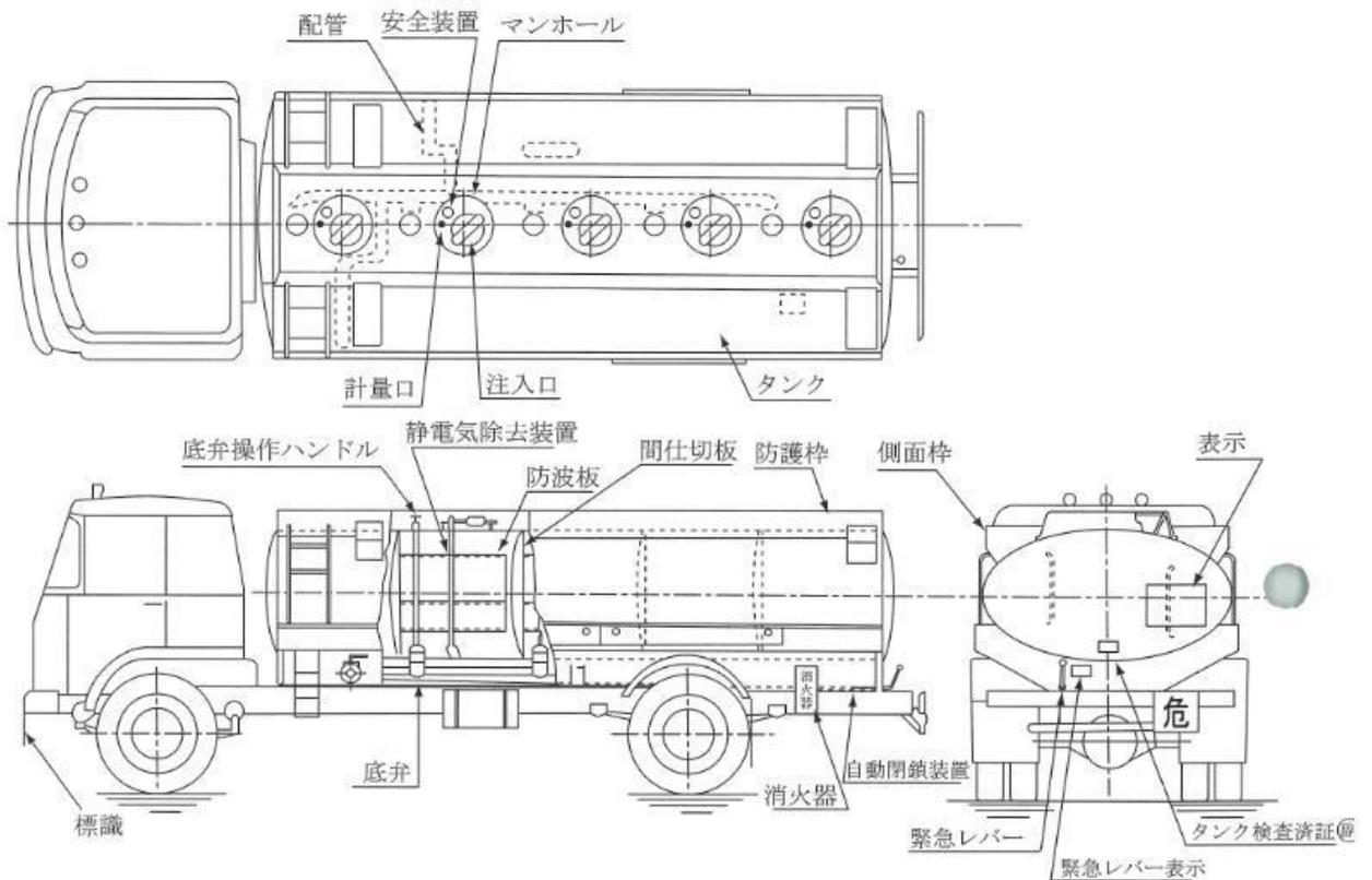
第 8-53 図 灯油等 (6,000 L 以下) を貯蔵し、又は取扱う移動タンク貯蔵所の例
