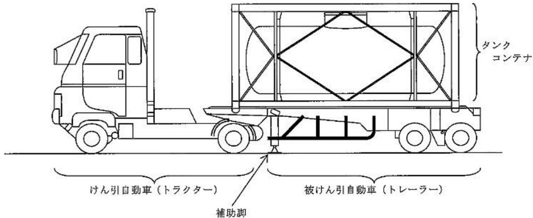
第8-72図 タンクコンテナを積載した自動車
