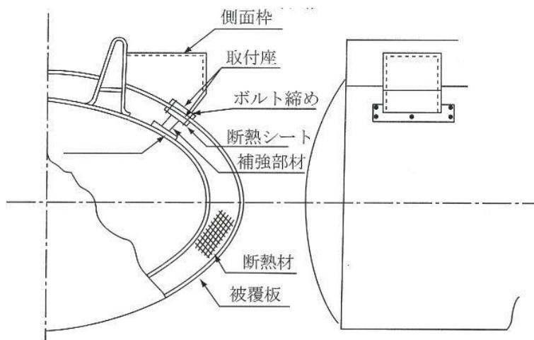
第8-20図 外板の下部に補強部材を設ける側面枠の例
