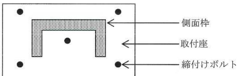
第 8-23 図 締付けボルト配列の例
