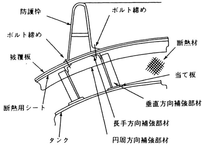
第 8-28 図 被覆板の下部に補強部材を設ける防護枠（ボルト締め接合する場合）
