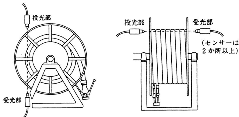
第8-64図 ホース巻取装置により検出する方法
