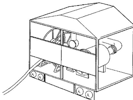
第 8-67 図 給油設備の扉による方法として認められない例
