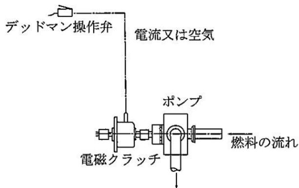
第 8-69 図 デッドマンコントロールシステム系統例
