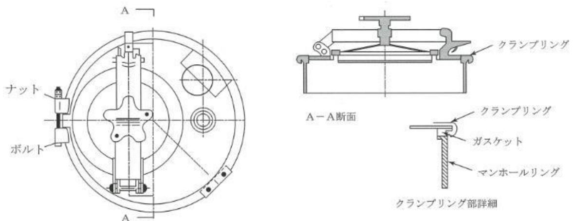
第8-7図 クランプリング方式のマンホールカバーの例
