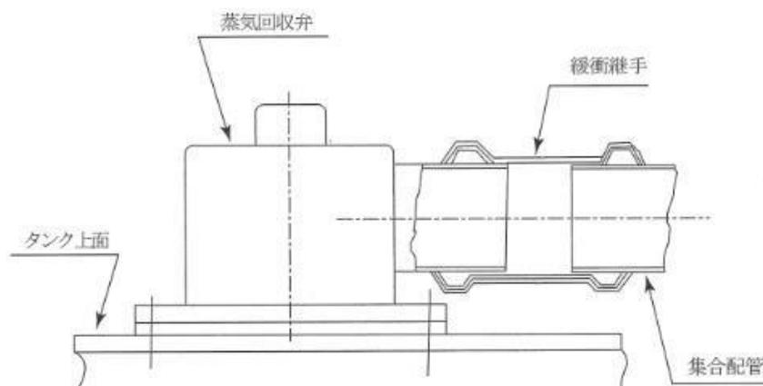
第8-12図 蒸気回収弁と集合配管との接続例
