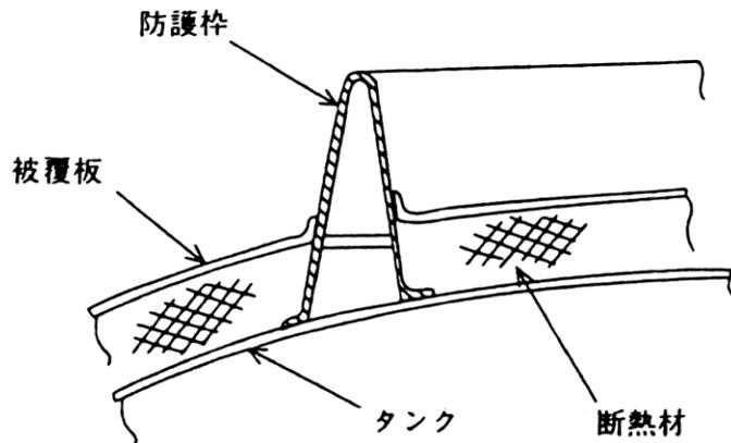
第 8-29 図 タンク胴板に直接取付ける防護枠
