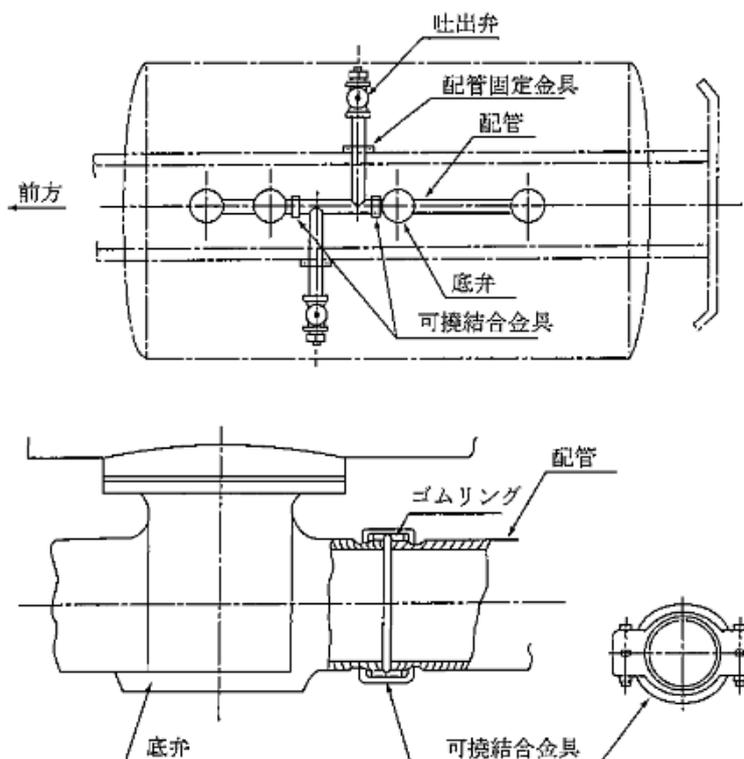
第 8-41 図 緩衝用継手による方法
