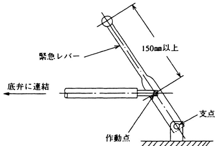
第8-34図 緊急レバーの構造
