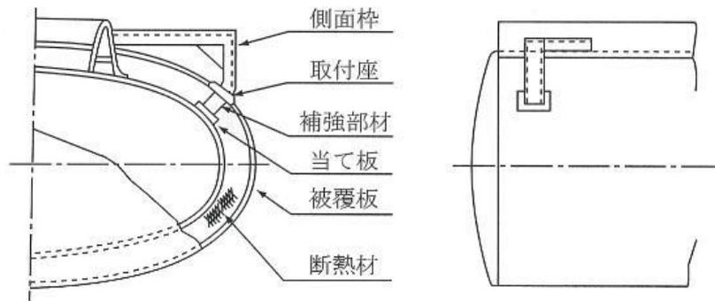
第8-19図 外板の下部に補強部材を設ける側面枠の例
