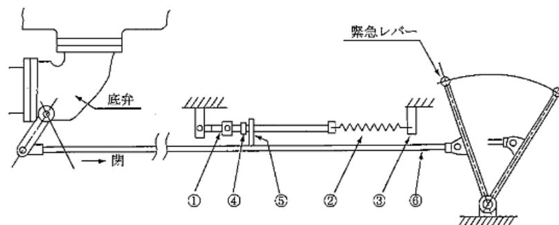
易溶性金属①が火炎によって加熱され溶断すると、易溶性金属と接続されているばね②がばね固定ピン③の方向に縮むので、ストップ④が受金⑤、ロッド⑥を押し動かすこととなり、底弁が自動的に閉鎖される。
