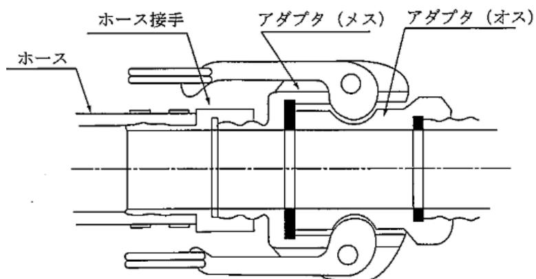
第8-43図 突合せ固定式結合金具の構造例
