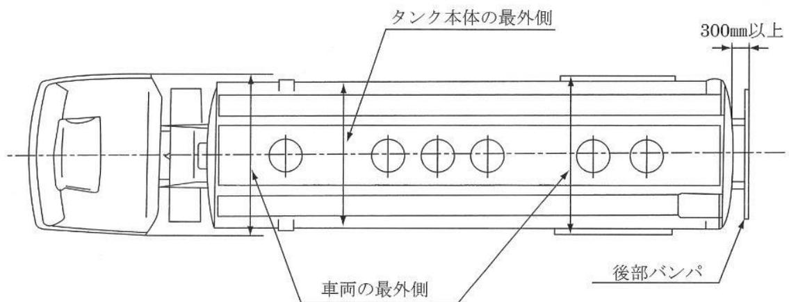
第 8-54 図 最大容量が 20 K L を超える移動タンク貯蔵所のタンク本体の位置の例
