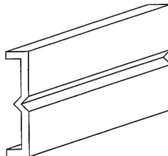
第 8 - 5 図 防波板の構造
