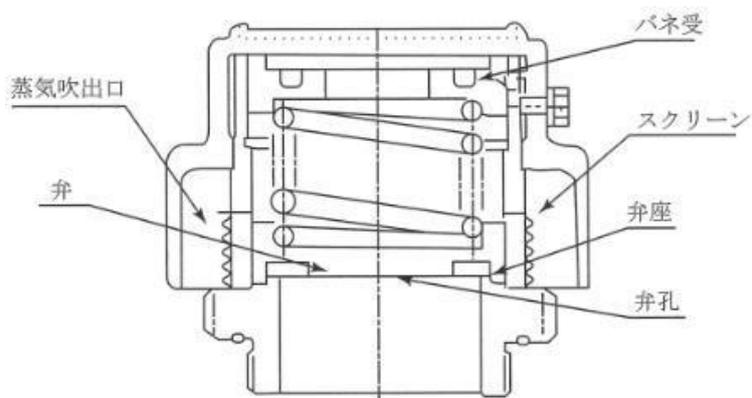
第8-4図 安全装置の構造例
