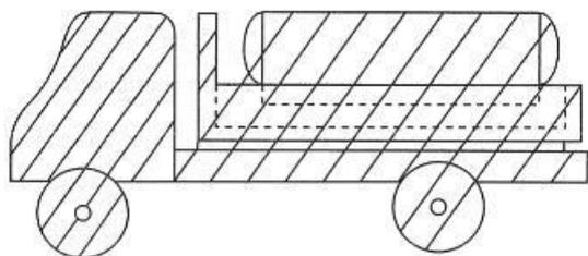
(ア) 移動貯蔵タンクの固定方法で、板厚が 3.2 mm 以上 6 mm 未満、容量 4,000 L のタンクに、受台、脚、ステージ等を溶接し、又はボルト締めによって強固に取り付
