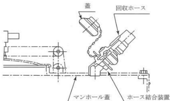
第8-9図 ホース結合装置の構造の例
