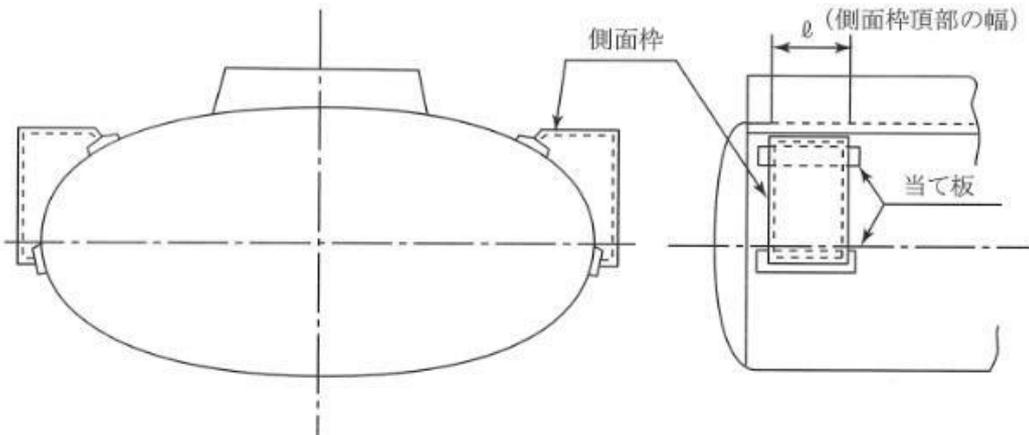
第 8-13 図 箱型の側面枠の構造例
