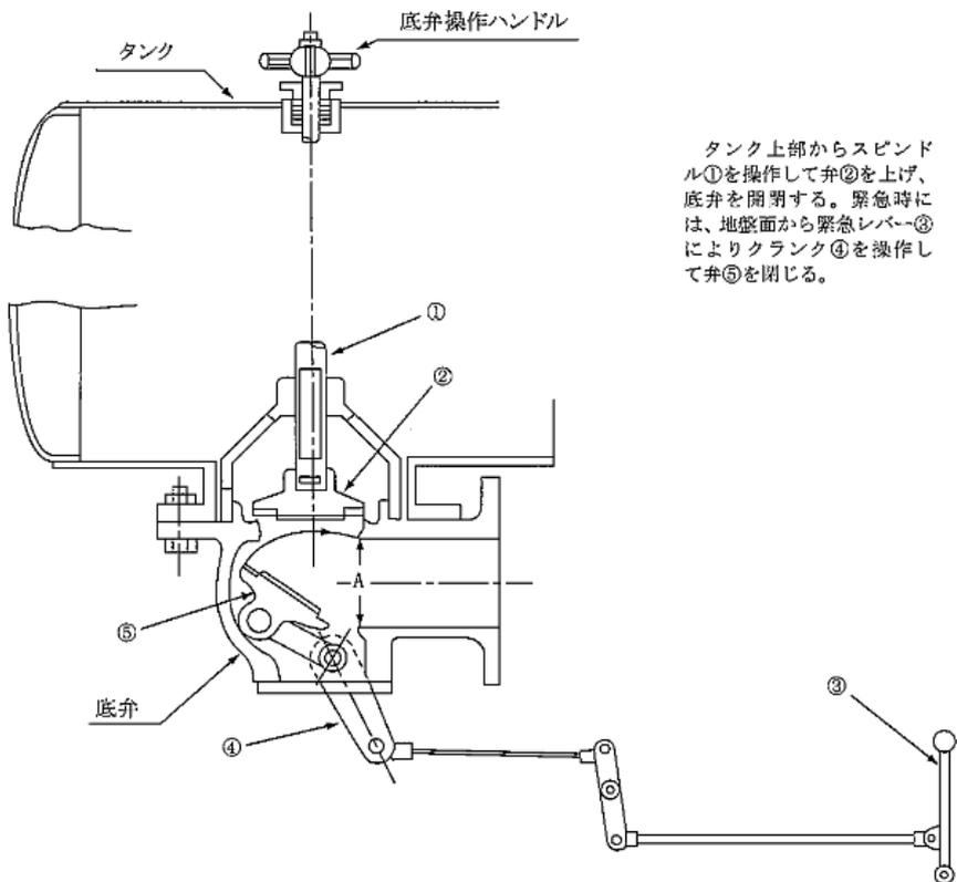
タンク上部からスピンドル①を操作して弁②を上げ、底弁を開閉する。緊急時には、地盤面から緊急レバー③によりクランク④を操作して弁⑤を閉じる。
