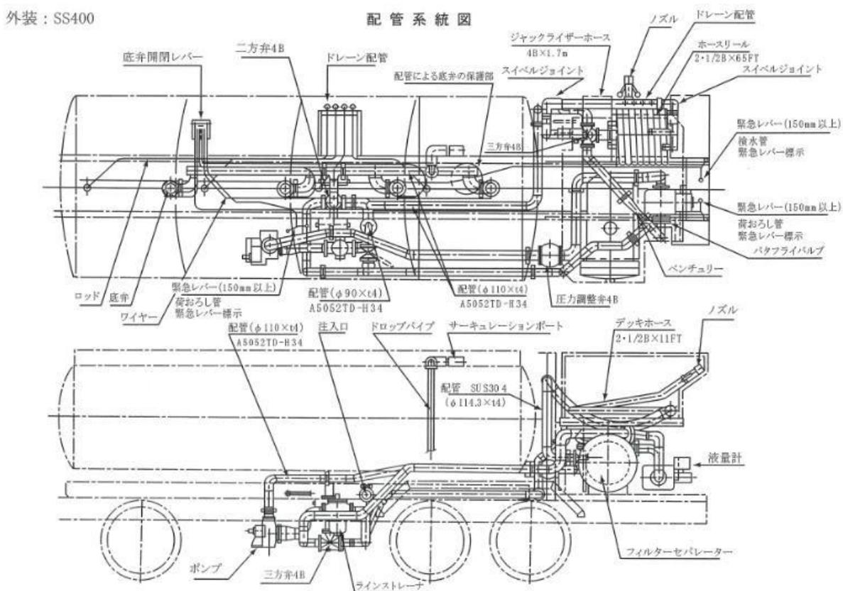
第 8-61 図 給油タンク車配管系統の例
