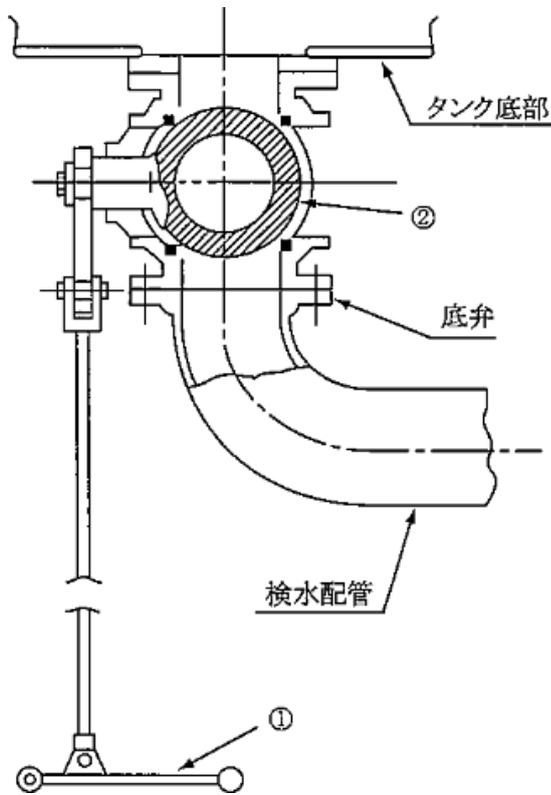
地盤面からレバー（緊急時併用）①を操作して弁口②を開閉する。緊急時には、緊急レバーによりレバー①を操作して、弁口②を閉じる。
