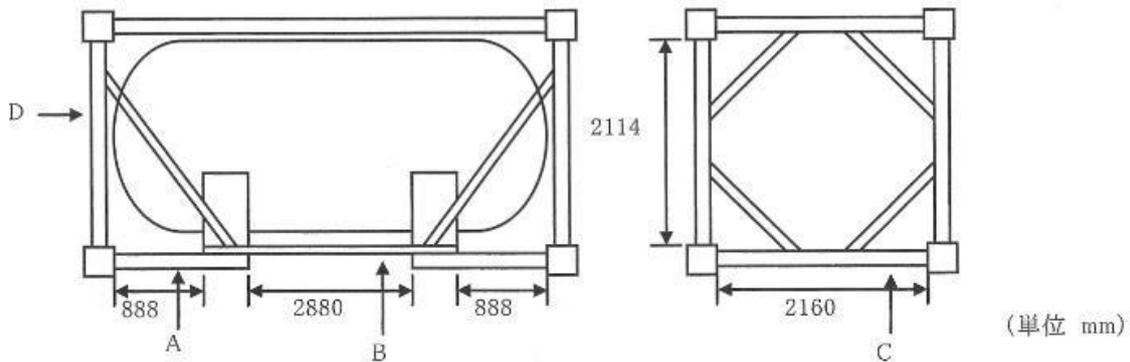
移動貯蔵タンクの移動方向に平行な荷重に対するはり下げたAの強度計算例
