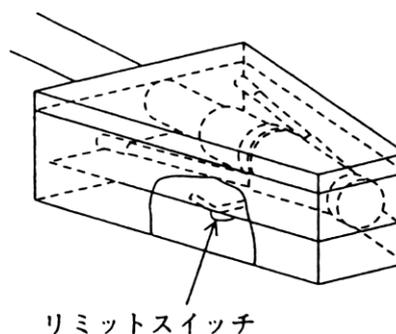
第8-65図 ノズル格納装置による方法の例
