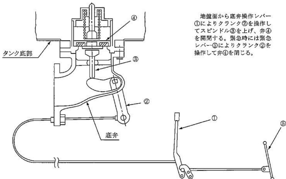
地盤面から底弁操作レバー①によりクランク②を操作してスピンドル③を上げ、弁④を開閉する。緊急時には緊急レバー⑤によりクランク②を操作して弁④を閉じる。
