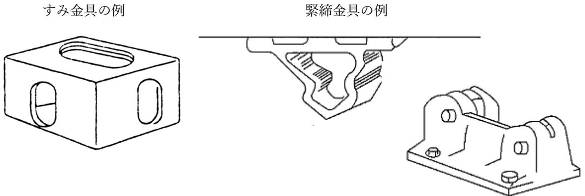
第 8-57 図 JIS により造られた緊締金具及びすみ金具の例
