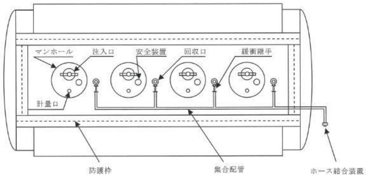
第8-10図 集合配管の取付け例
