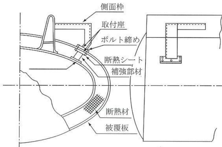
例2 枠型側面枠の場合
