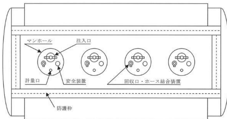
第8-8図 回収口に直接回収ホースを結合する方式の例
