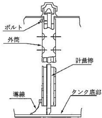
例3 外筒にフランジを溶接して取り付ける例
