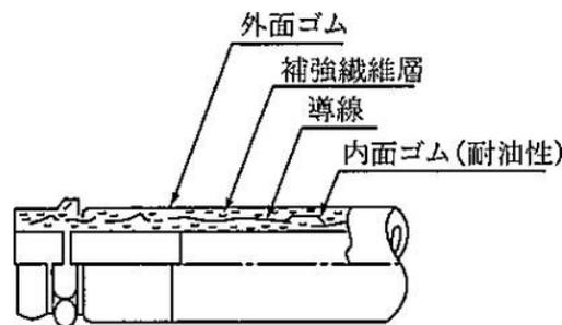
第8-70図 静電気を導通させる給油ホースの例
