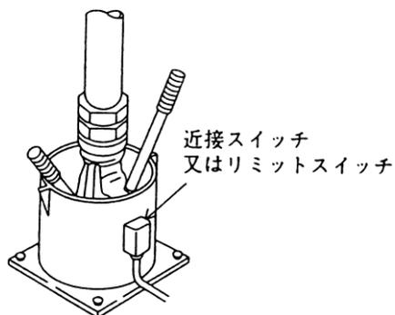
例2 クランプ式ノズル格納具の場合
