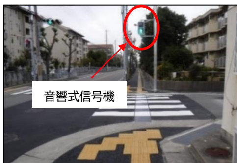
音響式信号機の設置
