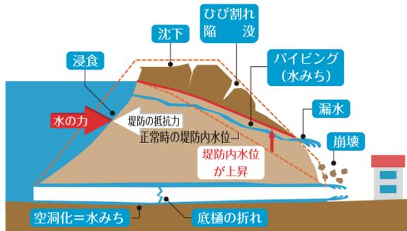
**地震時** ■堤体の陥没やひび割れが発生し、急激な漏水量（大規模地震時）の増加や漏水に濁りが生じた場合
