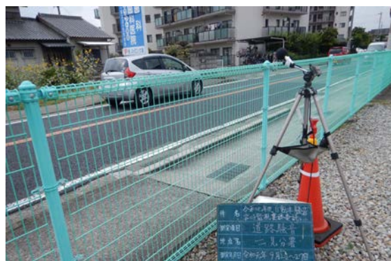
写真 4-6 騒音振動の測定
