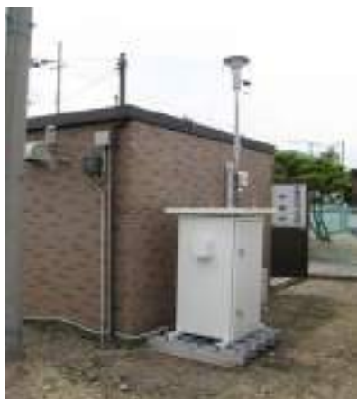
写真 4-4 大気汚染常時監視測定局
