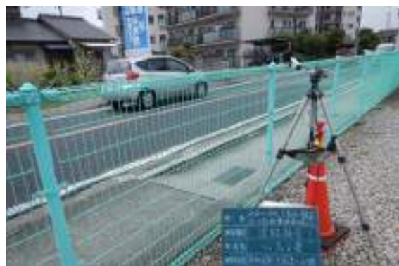
写真 4-6 騒音振動の測定
