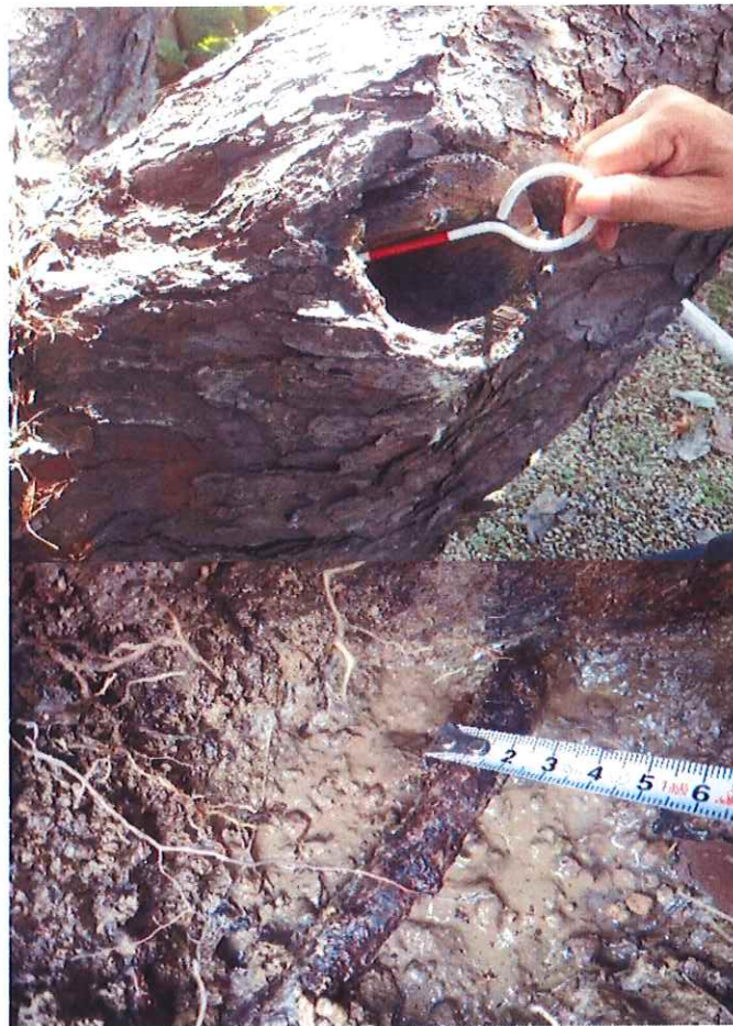
写真-5 空洞に検度棒を差し込む 約 50 cm の空洞を確認
